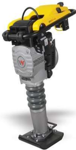
Abb. 16: Vibrationsstamper 70 kg Einsatz bei 3 Schüttlagen pro Höhenmeter
