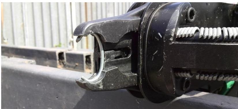
Abbildung 4 Pneumatikpresse für Drahtklammern
