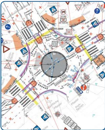
Die seitliche Verkehrsführung wurde mit einer Kombination aus Leitbord und entsprechender Markierung perfekt den Bedürfnissen, die der Verkehr an diese Baumaßnahme stellt, angepasst. In den Zufahrten bilden mobile Recycling-Inseln Fahrbahnteiler und Querungshilfen – je nach Bedarf.
