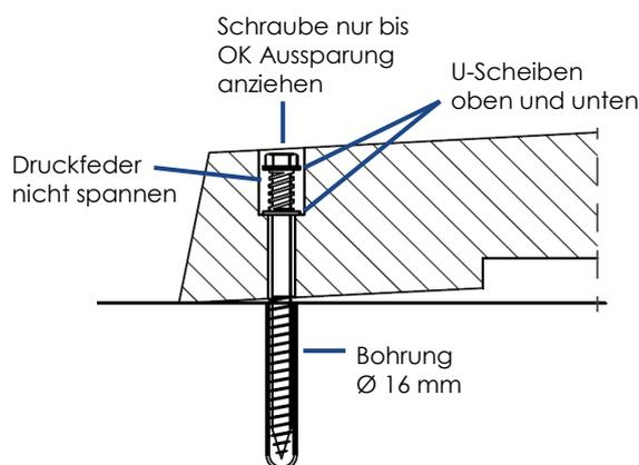
**Profilpfostenverankerung** bestehend aus Schloßschraube A2 mit Mutter und U-Scheibe. Pro Profilpfosten sind 3 Schrauben vorgesehen.
