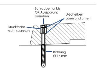
**Profilpfostenverankerung** bestehend aus Schloßschraube A2 mit Mutter und U-Scheibe. Pro Profilpfosten sind 3 Schrauben vorgesehen.
