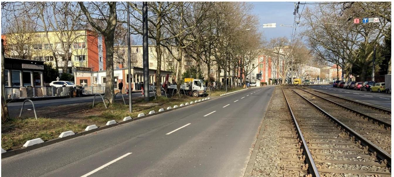
Zur Fahrbahnseite wurde der Bordstein erhöht, dadurch können die quer zur Fahrtrichtung befindlichen Parkplätze nicht mehr angefahren werden – besonders über die Geh- und Radwege.
