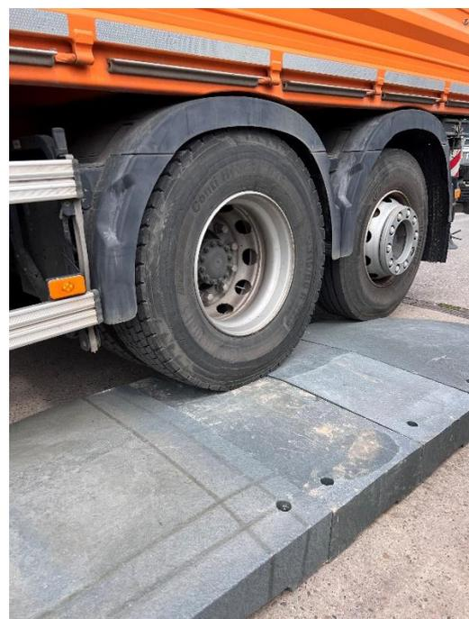
Im Zuge unserer regelmäßigen Qualitätsprüfung waren jetzt die Flexinseln an der Reihe. Realitätsnah haben wir die Inselemente verschraubt. Mit unserem 40-Tonner mit Kranaufbau und Anhänger sind wir mehrfach drüberfahren. Schnell, langsam, mittig, seitlich.....
